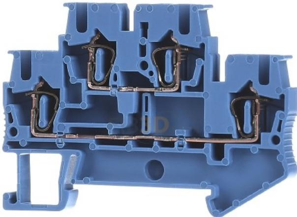
Номинальный ток In 22 А, Номинальное напряжение 500 V, Количество этажей 2, Количество точек зажима на уровень 2, Тип монтажа DIN-рейка TH35, Материал изоляционного корпуса другие, рабочая температура -60..105 °С, широкий 5,15 мм, рост 67,584246 мм, глубина 45,85 мм, Взрывобезопасная версия "Ех е" да, Требуется торцевая пластина да, цвет синий, Полы с внутренними мостами нет
