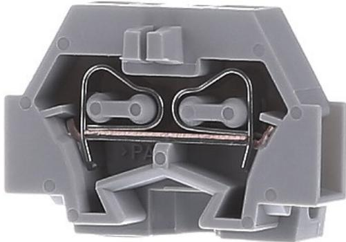
Взрывобезопасная версия "Ex e" нет, Номинальный ток In 18 A, Номинальное напряжение 400 V, Количество полюсов 1, Количество точек зажима на полюс 2, Тип монтажа другие, Материал изоляционного корпуса Термопластик, рабочая температура -30..85 °C, Без галогена да, широкий 5 mm, рост 25,1 mm, глубина 17,1 mm, Требуется торцевая пластина да, цвет серый, Прозрачный нет
