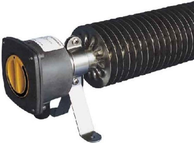
мощность 1500 W, Диаметр ребра 120 мм, напряжение 230 V, Автоматический регулятор температуры да, Низкая температура поверхности нет, Универсально подключаемый нет, Защита IP) IP67, рост 184 мм, широкий 145 мм, длина 900 мм, Взрывобезопасный нет, Для газа во взрывоопасной зоне без, Для пыли Ex-Zone без, Температурный класс согласно директиве 94/9 / EC без
