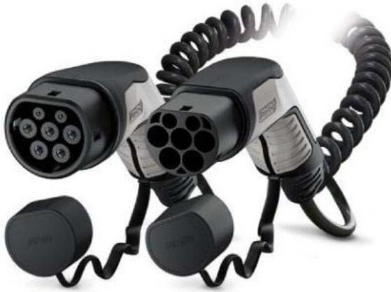
Тип тока 3-фазный переменный ток, Количество коммуникационных лидеров 2, Сторона машины казни Тип 2, Сторона инфраструктуры исполнения Тип 2, С Incable Control Box (ICCB) нет, Режим зарядки Mode 3, Номинальный ток 20 A, номинальное напряжение 480 V, С датчиком температуры нет, Длина кабеля 4 м, Тип кабеля спирализованный, Контактный материал другие, Контакты для обработки поверхности другие
