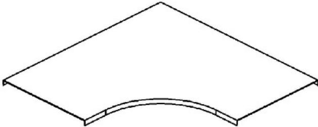
угол 90°, Смена направления horizontal, широкий 304 mm, Подходит для кабельного лотка да, Подходит для сетчатого кабельного лотка нет, Подходит для кабельных лестниц нет, Тип монтажа Поверните ручку, Навесной нет, Подходит для поддержания работоспособности да, материал Сталь, Качество материала другие, защита поверхности полоса оцинкованная
